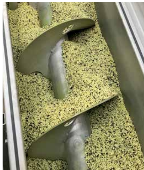
Mischanlagen sorgen für homogene Dünger, hier am Beispiel von Triplesuperphosphat und Alzon Neo-N.
